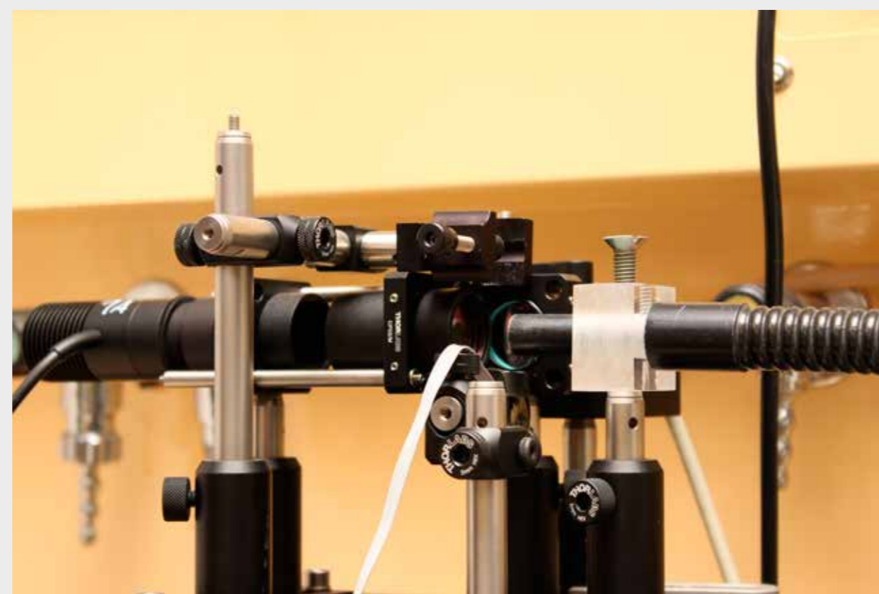
Foto 2: Vzorkovací prostor. Vlevo saturační světlo s nasazeným filtrem. Vpravo světlovodič vedoucí aktinické a měřící světlo. V pozadí dva za sebou nasazené filtry, za nimiž byl umístěn detektor. Uprostřed se nachází prostor pro květu se vzorkem ke kterému vede kabel pro magnetické míchadlo. Použité zařízení bylo sestaveno z individuálně zakoupených zdrojů světla.
